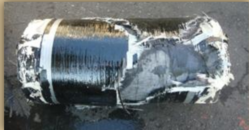
Type4. 몸통부 파열 (614bar) - 비금속 (탄소섬유복합재-신소재)
